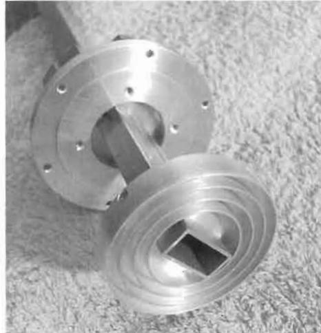
Zum Auffinden des Systemfokuspunktes wird der Hohlleiter axial in der Halterung verschoben und damit die höchste Leistung eingestellt
