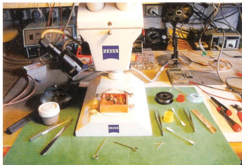
Bild 3: Prüfung aller Teile – optisch und ohmsch
